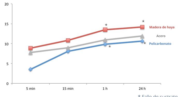
**COMPORTAMIENTO DEL MATERIAL CURADO****RESISTENCIA DE CIZALLA**
